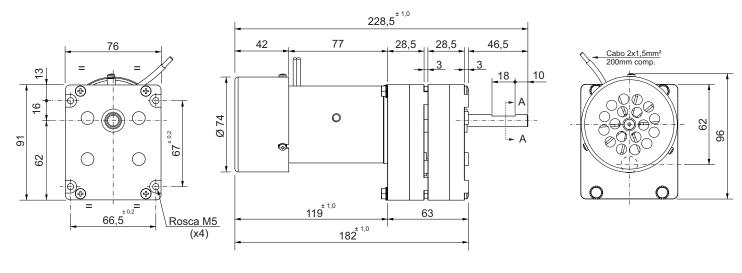
Dimensões em milímetros. Tolerâncias não especificadas ± 0,5 mm. Sujeito a alterações sem aviso prévio.
